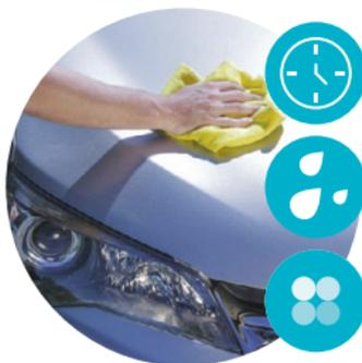
Warten Sie nach der Folierung mindestens drei Tage mit der nächsten Fahrzeugwäsche oder Wachsversiegelung und mindestens 30 Tage mit der nächsten Hochdruckreinigung.
