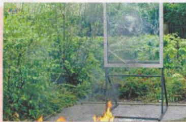
Nach der Tat: Die rückseitig mit Sicherheitsfolie geschützte Scheibe bricht kontrolliert, absorbiert dadurch die Wurfenergie, verhindert das Durchdringen der Wurfgeschosse (hier ohne Öffnung und Splitterabgang auf der Rückseite) und verbleibt vollständig im Rahmen.
